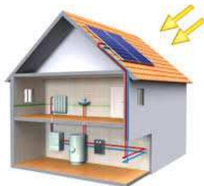
Mentre i pannelli fotovoltaici assorbono la luce del sole per trasformarla in energia elettrica, mentre i pannelli solari termici assorbono i raggi solari per riscaldare l'acqua, che può essere utilizzata per scopi igienico-sanitari (doccia, bagno, ecc.) oppure per usi termici, ad esempio per riscaldare l'acqua di una piscina o l'acqua di un riscaldamento a pavimento della casa.
